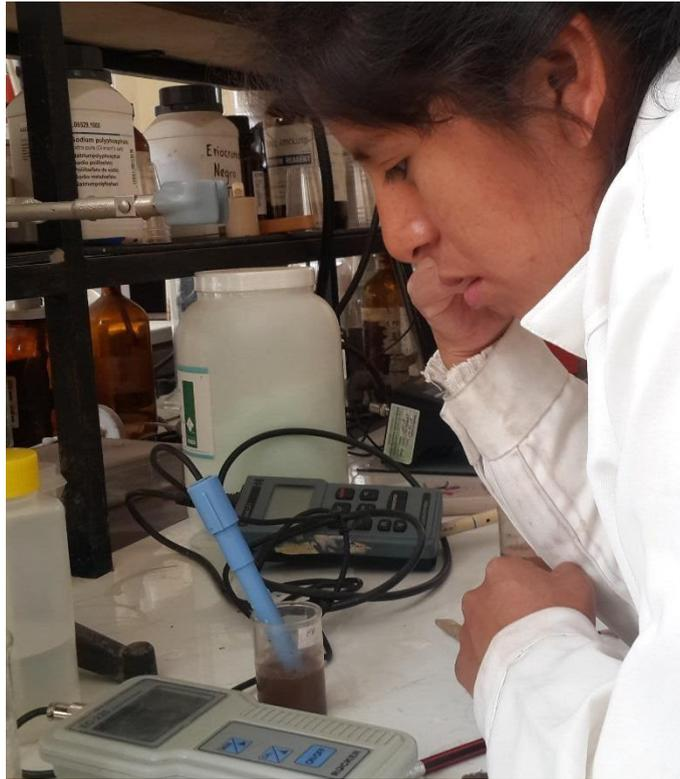
**Figura 08.** Determinación del PH del suelo en laboratorio de suelos y agua INIA SALCEDO -PUNO
